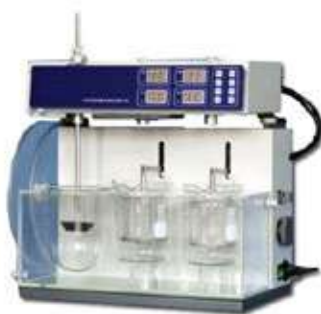
PJ-3 Тестер 4-в-1 Распадаемость, растворимость, твёрдость и истираемость таблеток
